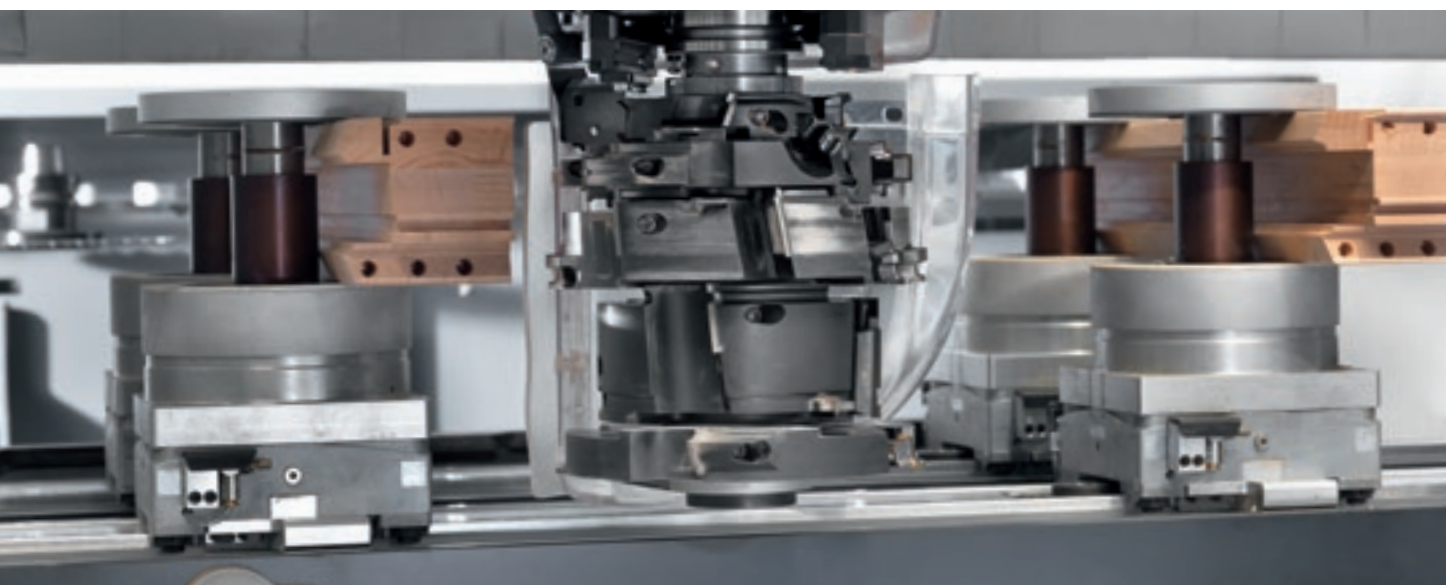
Пневматические системы фиксации Uniclamp и Hyperclamp с быстрым расцеплением для жесткой и точной фиксации.
