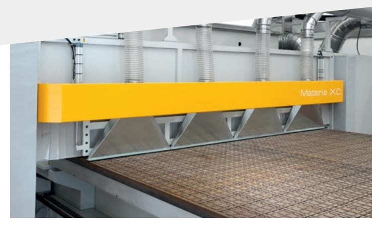
Возможность комплектования станка всасывающими соплами по ходу панели для более качественной очистки рабочей зоны и поддержания чистоты на производстве.
