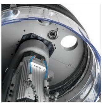
Система считывания положения с телекамерой для позиционирования по центру больших панелей во время цикла поступательно-вращательного движения, заложенного в программу обработки.
