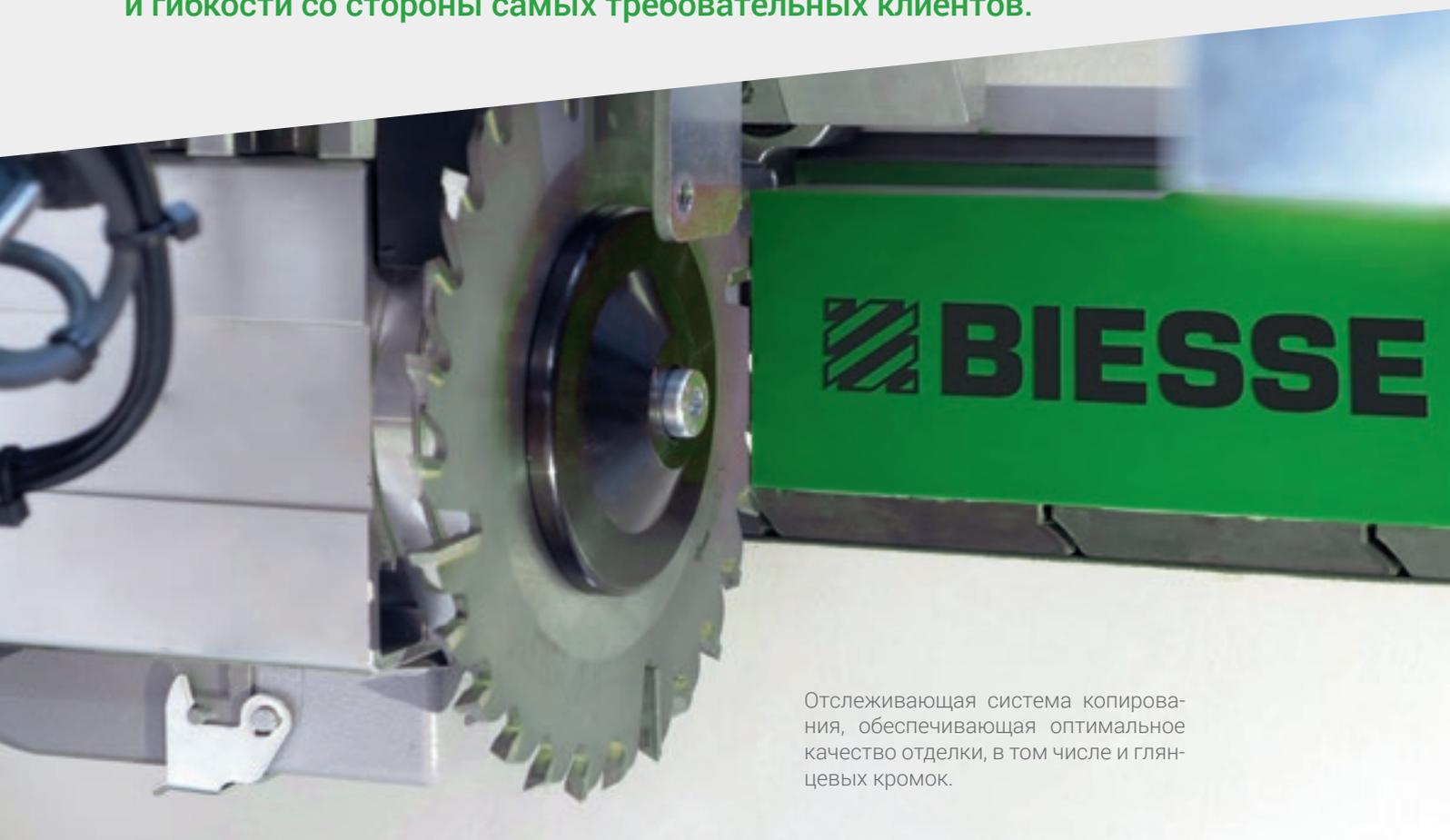
Отслеживающая система копирования, обеспечивающая оптимальное качество отделки, в том числе и глянцевых кромок.
