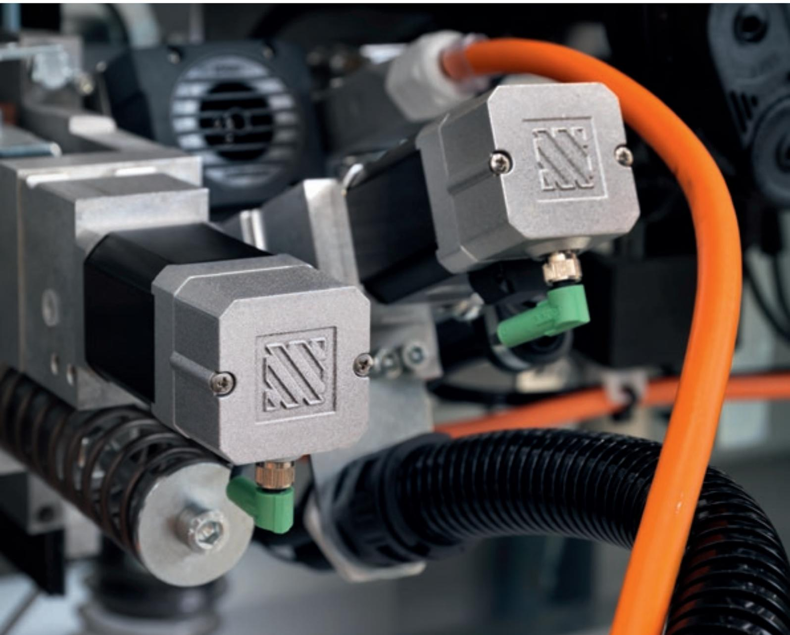
Автоматические оси рабочих групп имеют систему считывания, которая позволяет станку в любой момент “знать”, правильна ли настройка. Оси имеют допуск позиционирования с точностью до 1/100 мм для максимальной точности обработки. Компактные размеры значительно увеличивают область применения.
