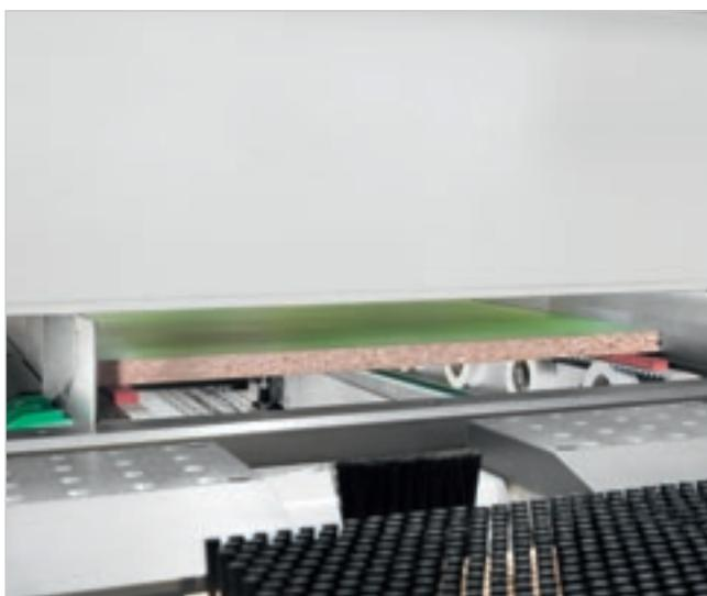
Направляющие выталкивателя, запатентованная система, содействующая выходу панели и позволяющая избежать любого дефекта.
