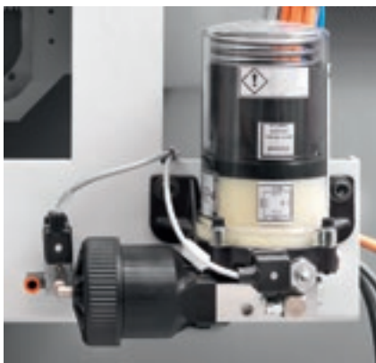
Система автоматической смазки сверлильной головы BHZ 29 2L.
