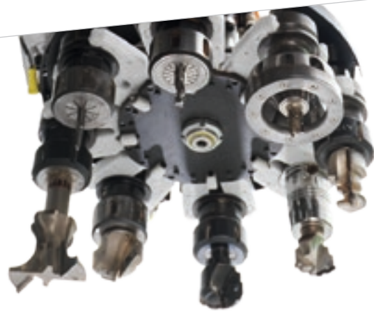
Инструментальный магазин револьверного типа на 8 мест.
