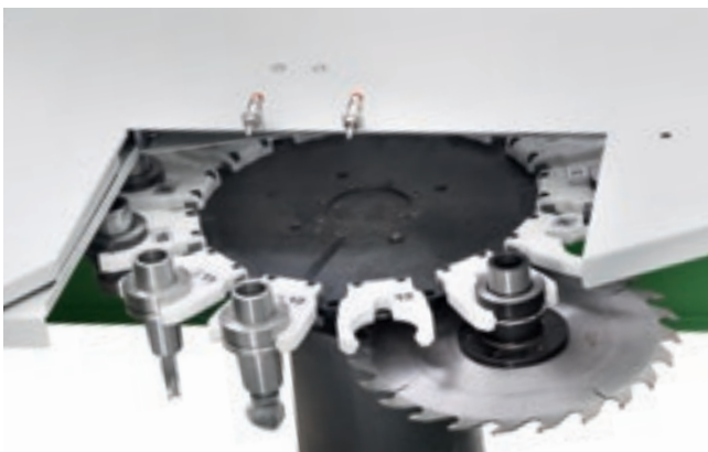
Инструментальный магазин револьверного типа на 13 или 16 мест.
