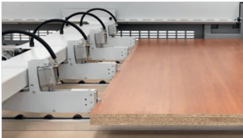
Аккуратное и быстрое позиционирование панелей с целью получения максимальной точности раскроя благодаря каретке толкателя, приводимой в действие бесколлекторным двигателем. Плоскость скольжения под толкателем оснащена бесприводными независимыми роликами во избежание царапания деликатных поверхностей панелей.
