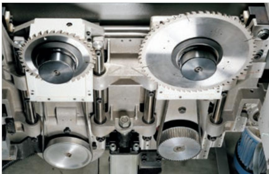
Оптимальное качество раскroя достигается при помощи **независимых перемещений** подъема и опускания основной и подрезной пил.
