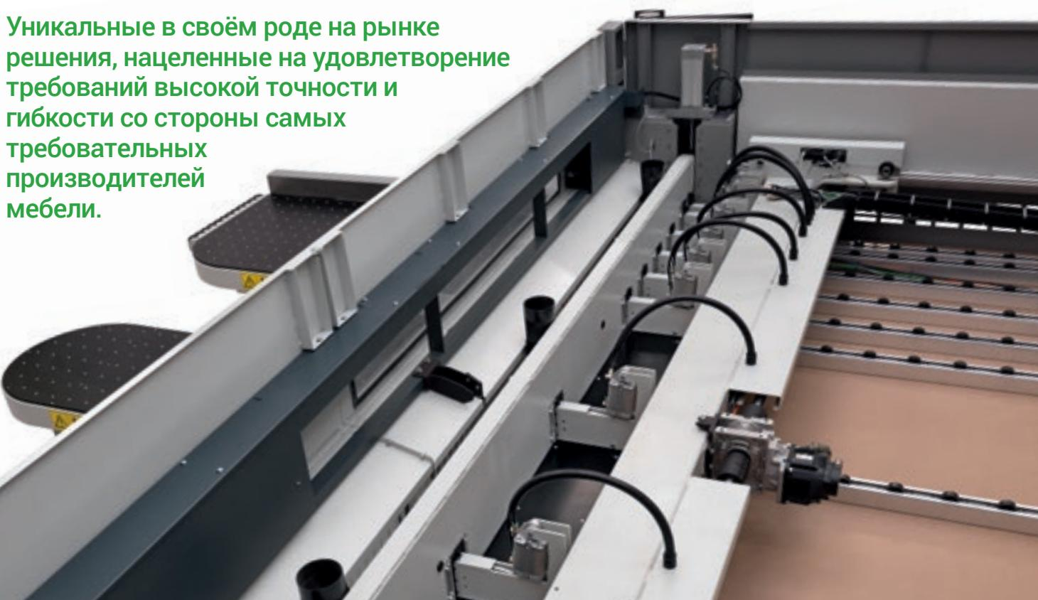
**Прижим** имеет структуру в виде единого элемента, который позволяет раздавать равномерное и контролируемое давление на стопу раскраиваемых панелей. Раскрытие оптимизируется автоматически в зависимости от толщины стопы панели для получения максимального качества обработки и сокращения времени цикла.
