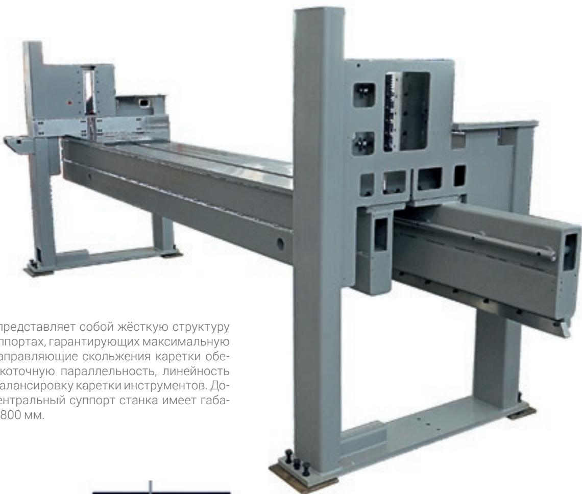
Станина станка представляет собой жёсткую структуру на массивных суппортах, гарантирующих максимальную стабильность. Направляющие скольжения каретки обеспечивают высокоточную параллельность, линейность и оптимальную балансировку каретки инструментов. Дополнительный центральный суппорт станка имеет габариты 3800 мм x 3800 мм.
