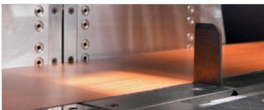
Высокоточное выравнивание тонких и гибких панелей с сокращением до минимума времени цикла благодаря **упору бокового выравнивателя**, встроенного в каретку пил.
