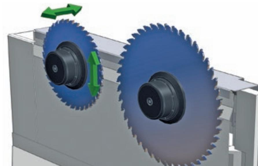
Быстрая и точная настройка инструментов благодаря электронной регулировке подрезной пилы при помощи устройства Digiset.
