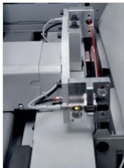
Автоматическое выравнивание подрезной пилы. Патентованная система способна автоматически выравнивать подрезную пилу относительно новой основной пилы за считанные секунды. Позволяет сократить время на оснащение, на пробныерезы и на контроль ошибок, увеличивая производительность и снижая затраты на заточку.
