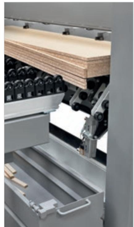
Продольные обрезки эвакуируются при помощи соответствующего люка с бесприводными роликами, работающего полностью автоматически.
