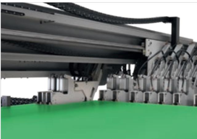
Система для одновременного исполнения различных поперечных резов, состоящая из двух толкателей, полностью механически независимых друг от друга, с двумя полностью независимыми бесприводными зажимами.
