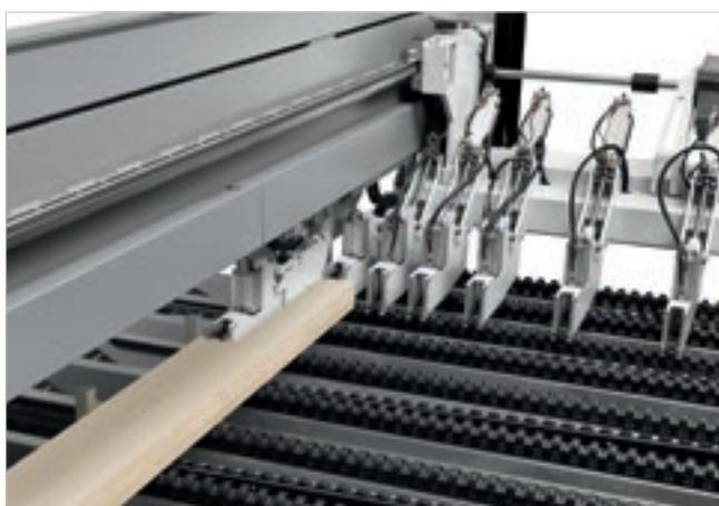
Система для одновременного исполнения различных поперечных резов, состоящая из двух толкателей, с одним бесприводным зажимом, всё это полностью механически независимо друг от друга.
