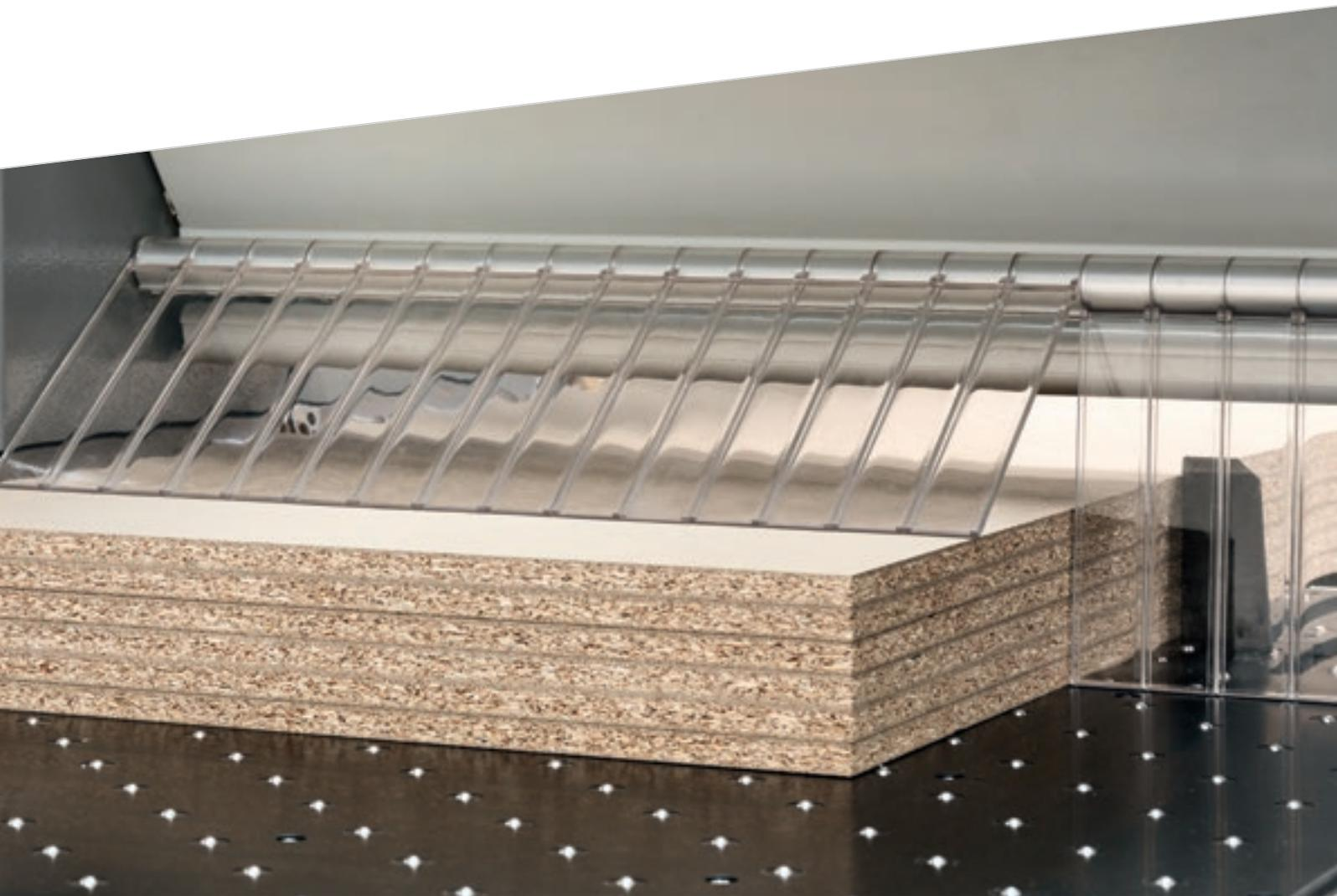
Упор бокового выравнивателя, установленный на поперечной каретке пил. Его характеристики позволяют выравнивать даже самые тонкие и / или гибкие панели, сокращая до минимума время цикла.
