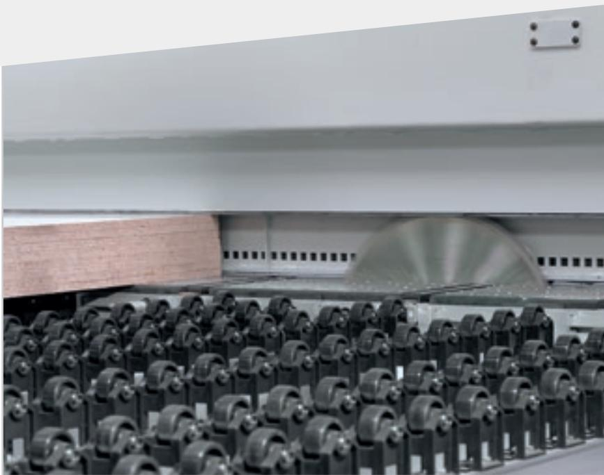
Прижим имеет двоякую независимую структуру, позволяющую производить равномерное и управляемое прижатие пачки раскраиваемых панелей благодаря отсутствию вырезов для ввода зажимов и созданию самой настоящей герметичной камеры при отделении обрезка, что даёт возможность получать эффективную работу вытяжки опилок.
