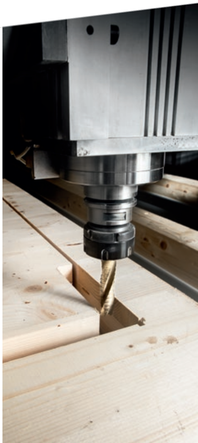
Высокая производительность благодаря синхронному электрошпинделю мощностью 22 кВт.
