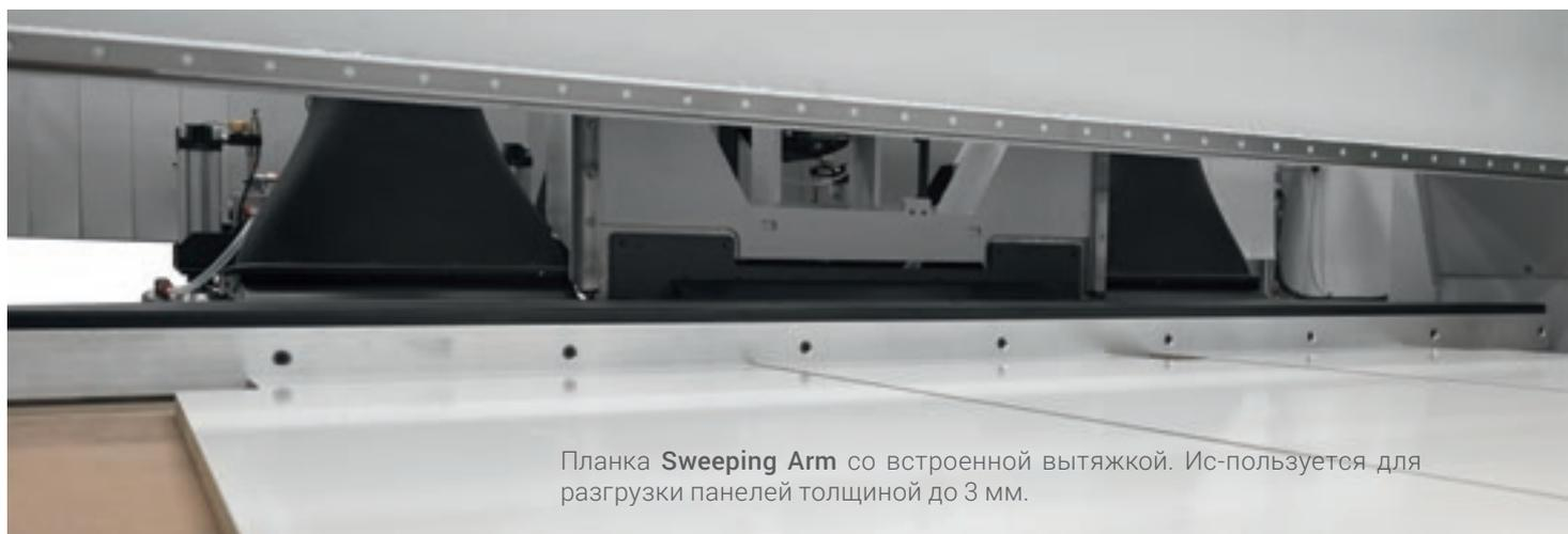
Планка **Sweeping Arm** со встроенной вытяжкой. Используется для разгрузки панелей толщиной до 3 мм.
