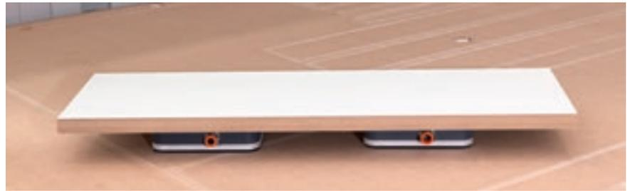
**непосредственно на подкладочной плите вакуумные модули.** Модули могут использоваться также и без вспомогательной вакуумной системы простым и быстрым способом, не сказываясь при этом на удерживании панели.
