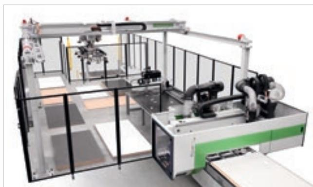
**Winstore** позволяет располагать подлежащими обработке панелями в любой момент без частых смен стоп материала, что значительно повышает производительность ячейки по сравнению с решениями, которые предусматривают загрузку стоп при помощи погрузчика.
