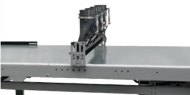
Система с 2 - 4 вытяжками, расположенная над ленточным транспортером выгрузки.
