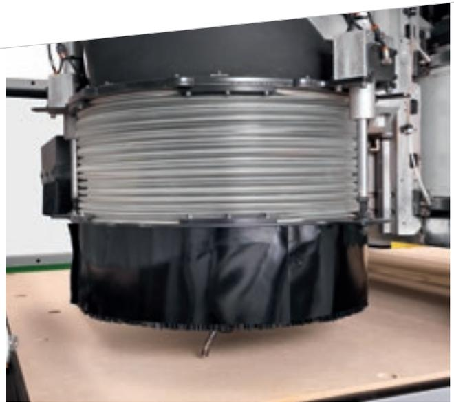
**Новые регулируемые вытяжные кожухи**, на 12 позиций (3 оси) или 19 позиций (5 осей) и полное покрытие щетины. Это решение позволяет точно регулировать положение кожуха, значительно повышая эффективность вытяжки.
