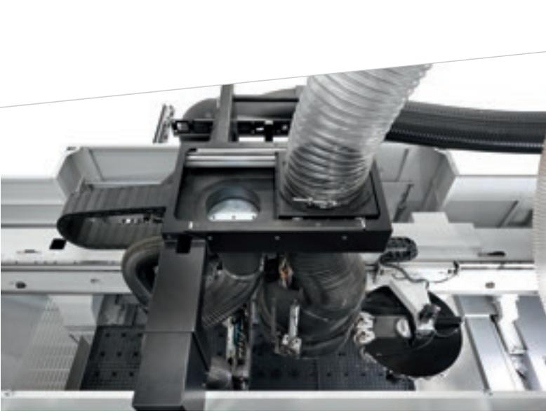
Rover B FT оснащен новой вытяжной системой рабочих блоков, чрезвычайно эффективной, с долговременной надежностью, которая предназначена для максимальной очистки изделия и рабочего помещения.
