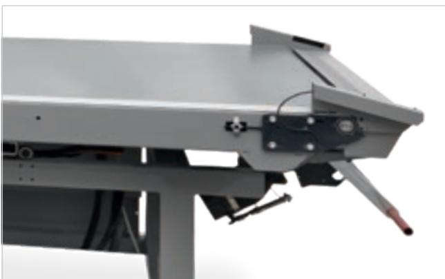
Всасывающий коллектор расположен в конце ленточного транспортера.
