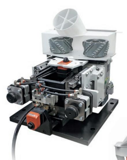
Прифуговочная группа RT20 с 2 двигателями и автоматическим подводом для обеспечения качественной поверхности под приклейку кромки. Новый способ оптимизации системы аспирации гарантирует полную чистоту.
