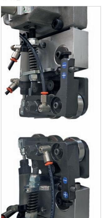
Щёточная группа для очистки и полировки кромки и панели.
