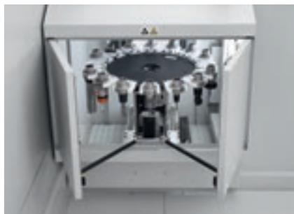
Кроме того, станок с правой стороны может быть оснащен вращающимся накопителем (вмещающим до 16 инструментов) для ускорения оснастки станка инструментом.
