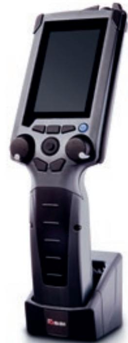
Ручной клавишный пульт для управления осью в ручном режиме, необходимый при подготовке рабочей зоны и оснастки станка инструментом.
