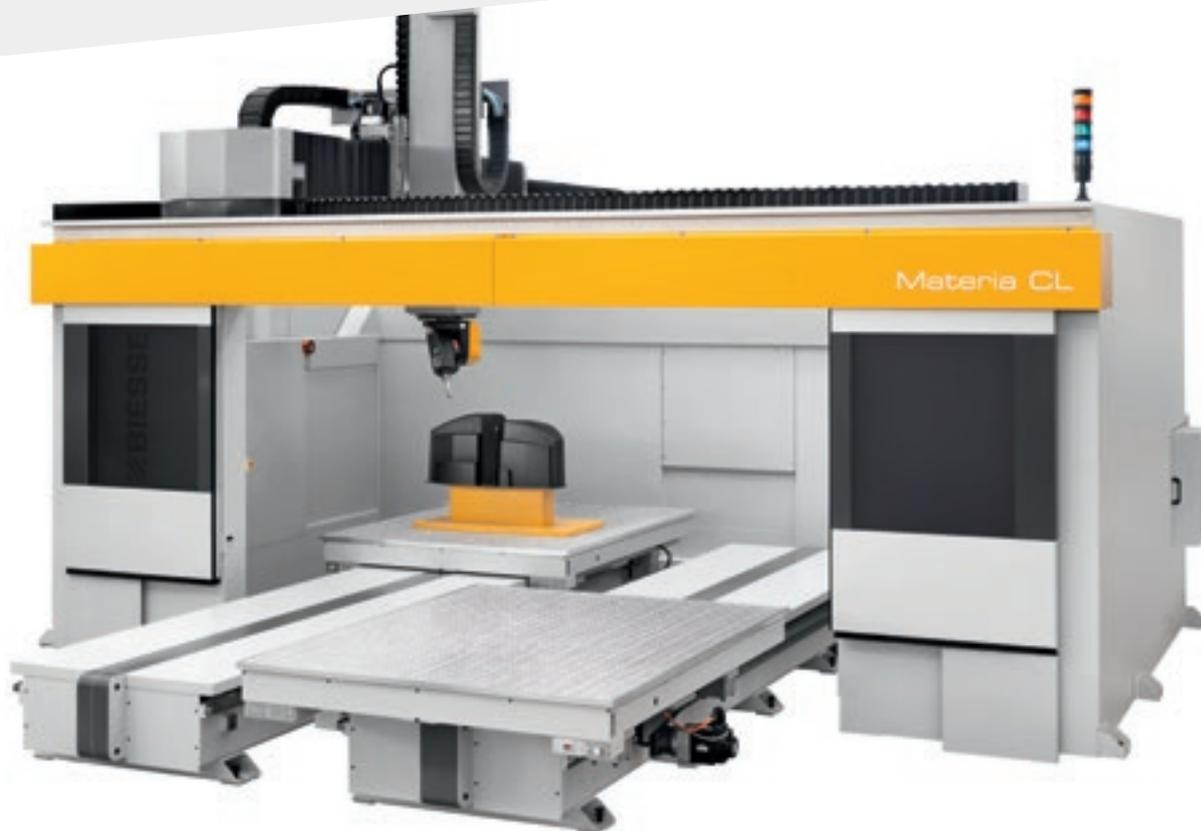
**МАКСИМАЛЬНАЯ ПРОИЗВОДИТЕЛЬНОСТЬ И ЭФФЕКТИВНОСТЬ. БЛАГОДАРЯ СИСТЕМЕ ПЕРЕДАЮЩЕГО СТОЛА ИСКЛЮЧАЮТСЯ ПРОСТОИ МЕЖДУ ОБРАБОТКАМИ, ПЕРЕМЕЩЕНИЕ ОСУЩЕСТВЛЯЕТСЯ БЫСТРО И БЕЗОПАСНО.**
