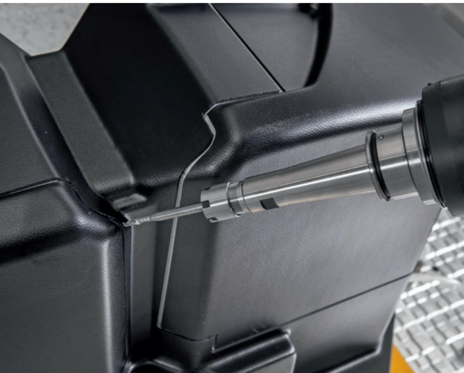
УЛЬТРАСОВРЕМЕННЫЙ ПЛАТФОРМЕННЫЙ ОБРАБАТЫВАЮЩИЙ ЦЕНТР MATERIA CL ОСОБЕННО ПОДХОДИТ ДЛЯ ФРЕЗЕРОВАНИЯ И РЕЗКИ ТРЕХМЕРНЫХ ЭЛЕМЕНТОВ В АВТОМОБИЛЕСТРОЕНИИ, АВИАЦИОННО-КОСМИЧЕСКОЙ И СУДОСТРОИТЕЛЬНОЙ ОТРАСЛЯХ.
