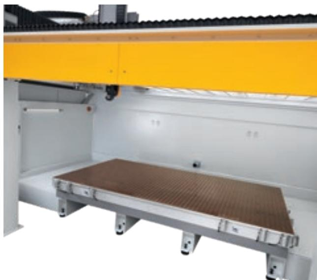
Сетчатая поверхность позволяет оператору вставлять прокладку в любую конфигурацию, создавая специальную зону вакуума. Внутренняя камера обеспечивает равномерное распределение вакуума по всему рабочему столу.
