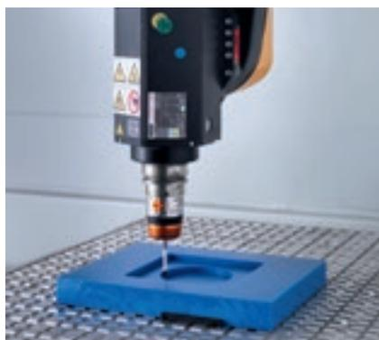
Обработка центр Materia CL может быть оснащена контактным индикатором толщины или лазерным датчиком для предварительной настройки инструмента и радиочастотным индикатором толщины для получения координат и размеров детали. В зависимости от типа выполняемой механической обработки станок Materia CL может быть оснащён системой охлаждения/смазки с распылением вне шпинделя или просто системой подачи сжатого воздуха.
