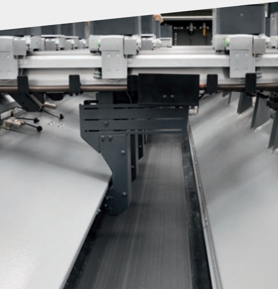
Ленточный транспортёр с электроприводом для удаления стружки и обрезков.
