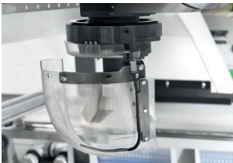
Дефлектор стружки, управляемый ЧПУ.
