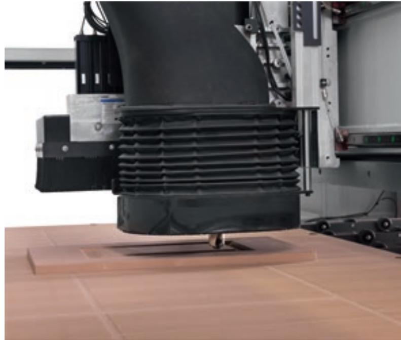
Вытяжной кожух с 12 программируемыми позициями и использование полного покрытия для гарантии максимальной эффективности вытяжки.
