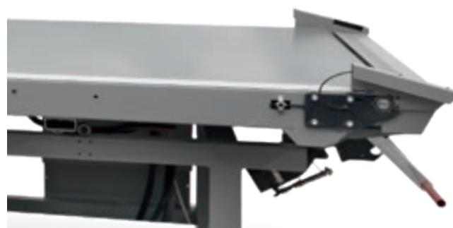
Всасывающий коллектор расположен в конце ленточного транспортера.
