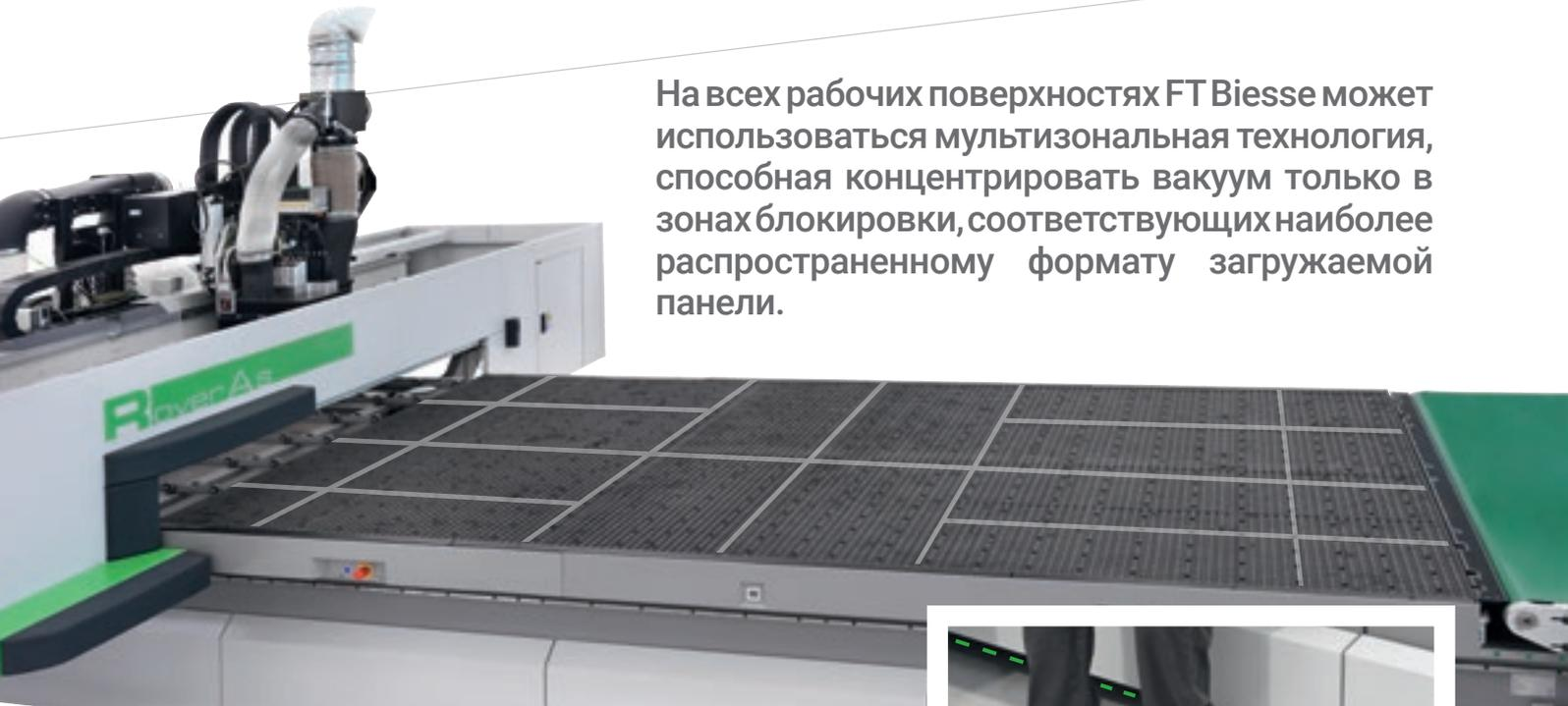
На всех рабочих поверхностях FT Biesse может использоваться мультizonальная технология, способная концентрировать вакуум только в зонах блокировки, соответствующих наиболее распространенному формату загружаемой панели.
