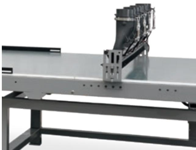
Система с 2 - 4 вытяжками, расположенная над ленточным транспортером выгрузки.
