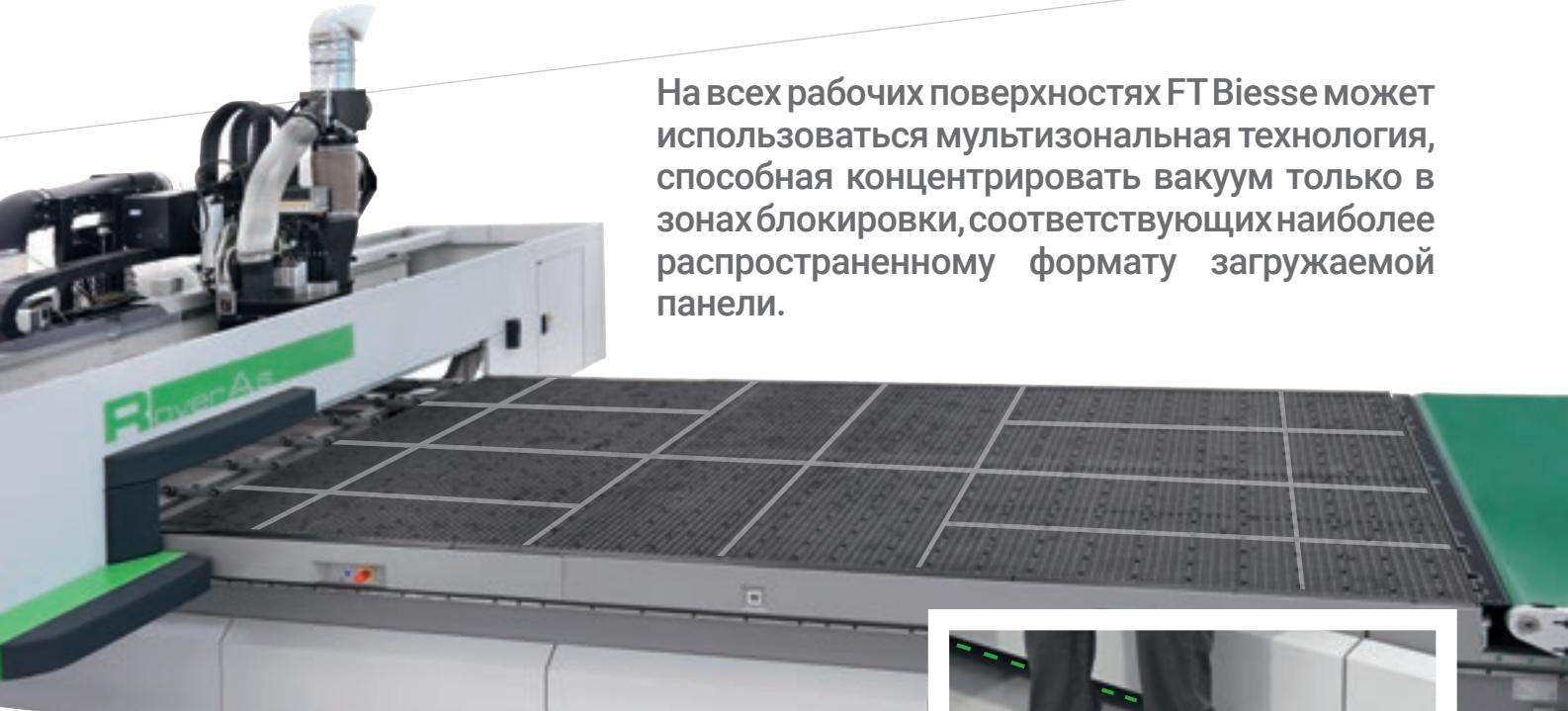
На всех рабочих поверхностях FT Biesse может использоваться мультизональная технология, способная концентрировать вакуум только в зонах блокировки, соответствующих наиболее распространенному формату загружаемой панели.
