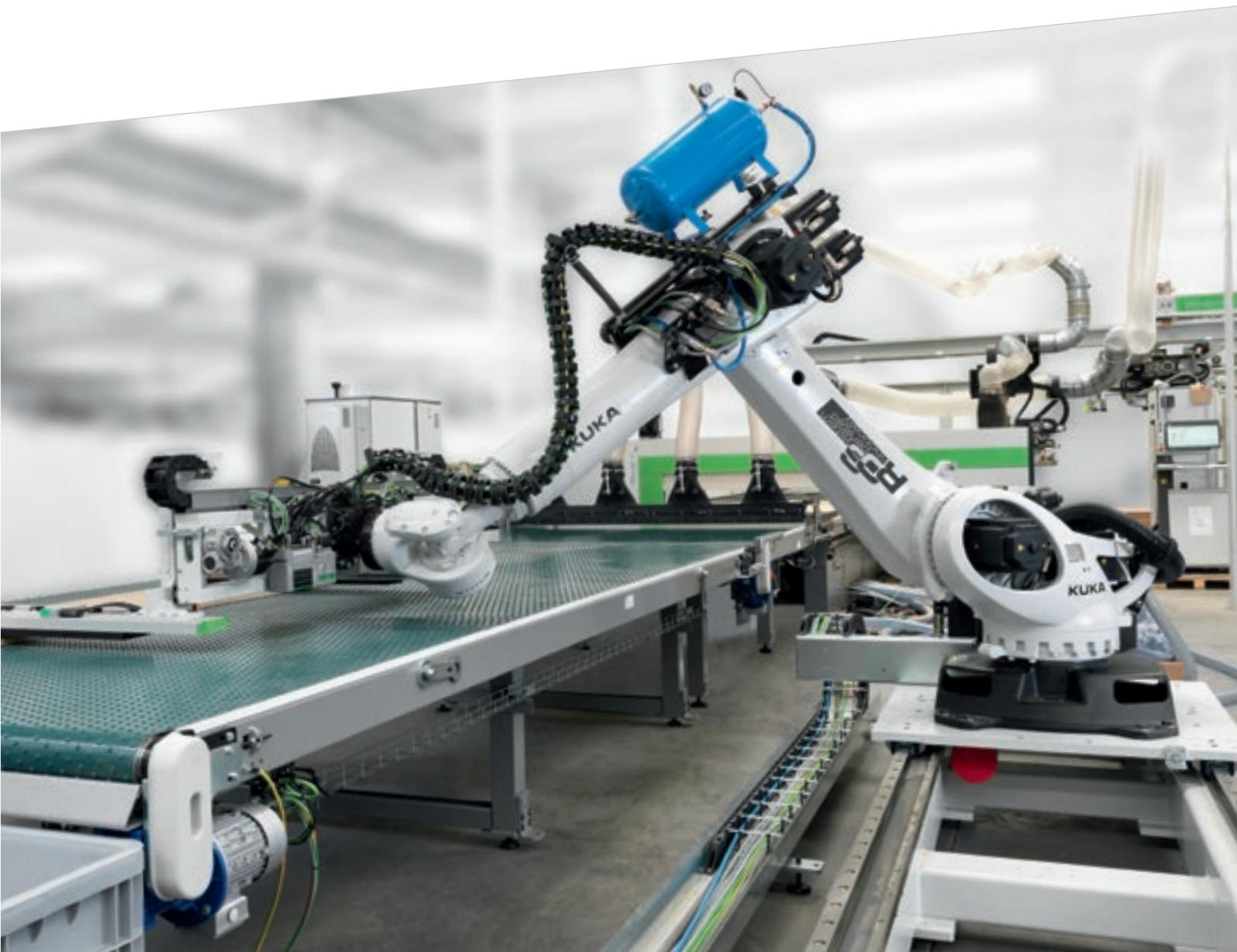
Rover A идеально интегрируется на линии с роботами (ROS) и системами загрузки и выгрузки. ROS гарантируют значительное повышение производительности, а также полную надежность производственного процесса, как загрузочных/разгрузочных операций, так и в более обширном контексте промышленной автоматизации.
