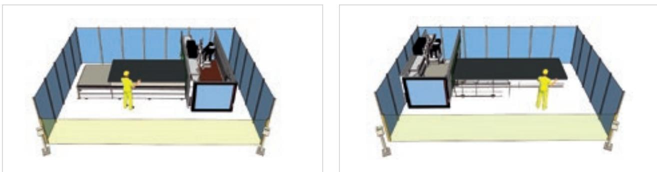
Станок может быть настроен с tandemной загрузкой для попеременной обработки панелей. Это позволяет выполнять загрузку или разгрузку во время операций по обработке.
