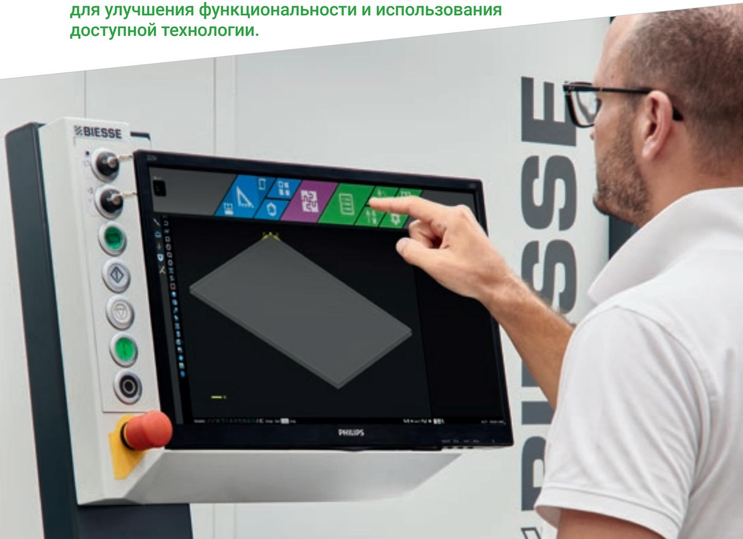
**bTouch - это новый сенсорный экран 21,5", позволяющий выполнять все функции, выполняемые мышью и клавиатурой, обеспечивая прямую интерактивность между пользователем и устройством.**
