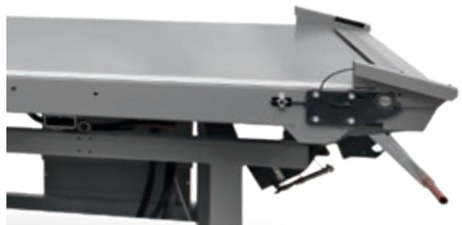
Всасывающий коллектор расположен в конце ленточного транспортера.
