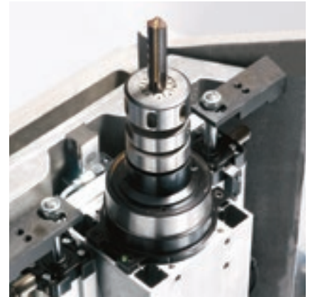
Электрошпиндели с креплением HSK D-50.
