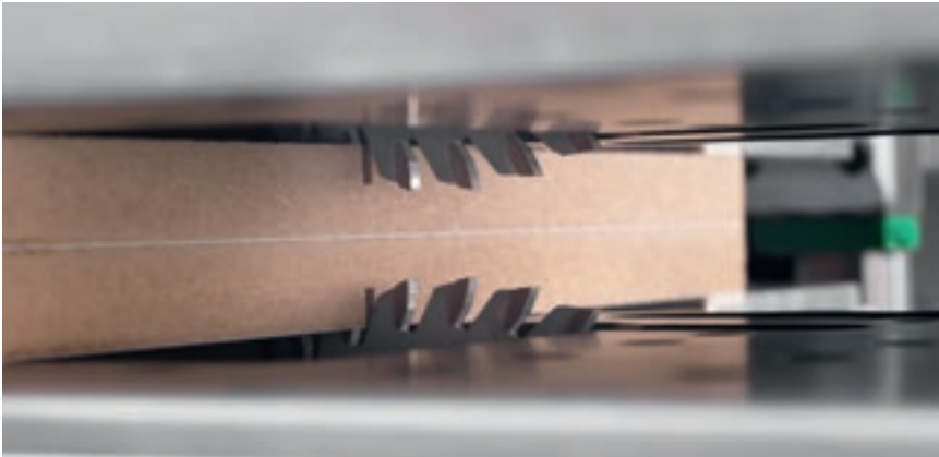
Пильная группа для пазования вдоль оси X.
