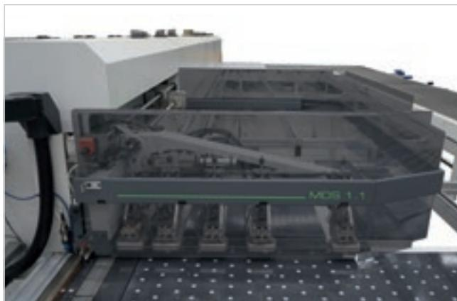
Механическая планка обеспечивает корректный ввод и перпендикулярность панелей с чрезвычайной простотой.
