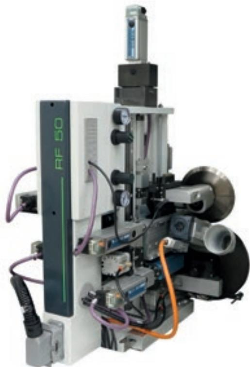
**Циклевальные группы углов и кромки позволяют добиться максимальной повторяемости обработки за счет контроля толщины панели в режиме реального времени.**
