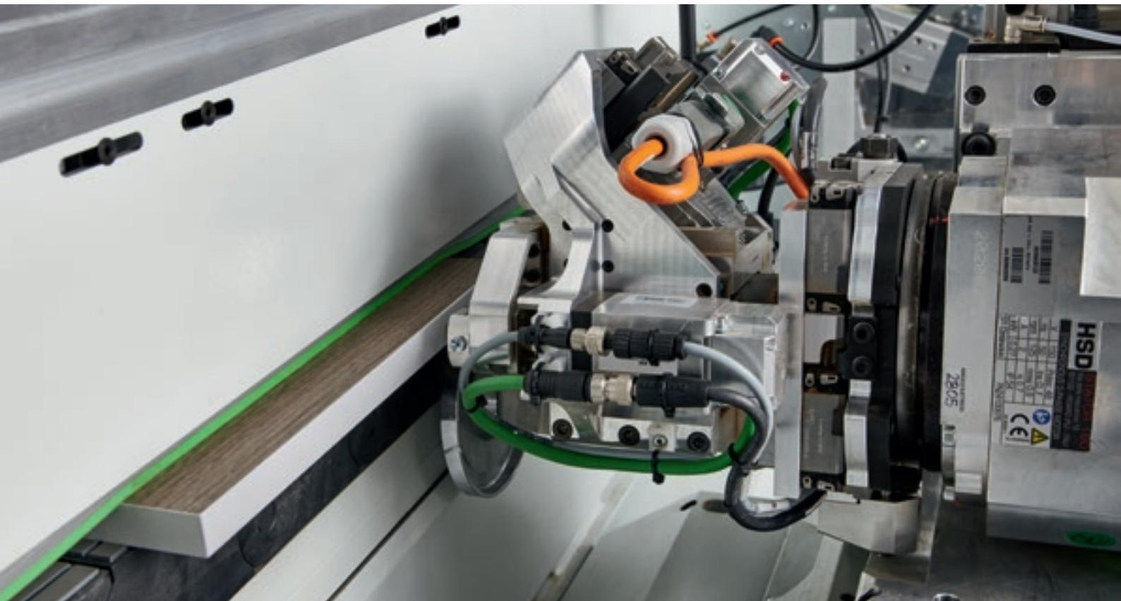
Динамический контроль копирования на панели для обеспечения максимальной повторяемости обработки.
