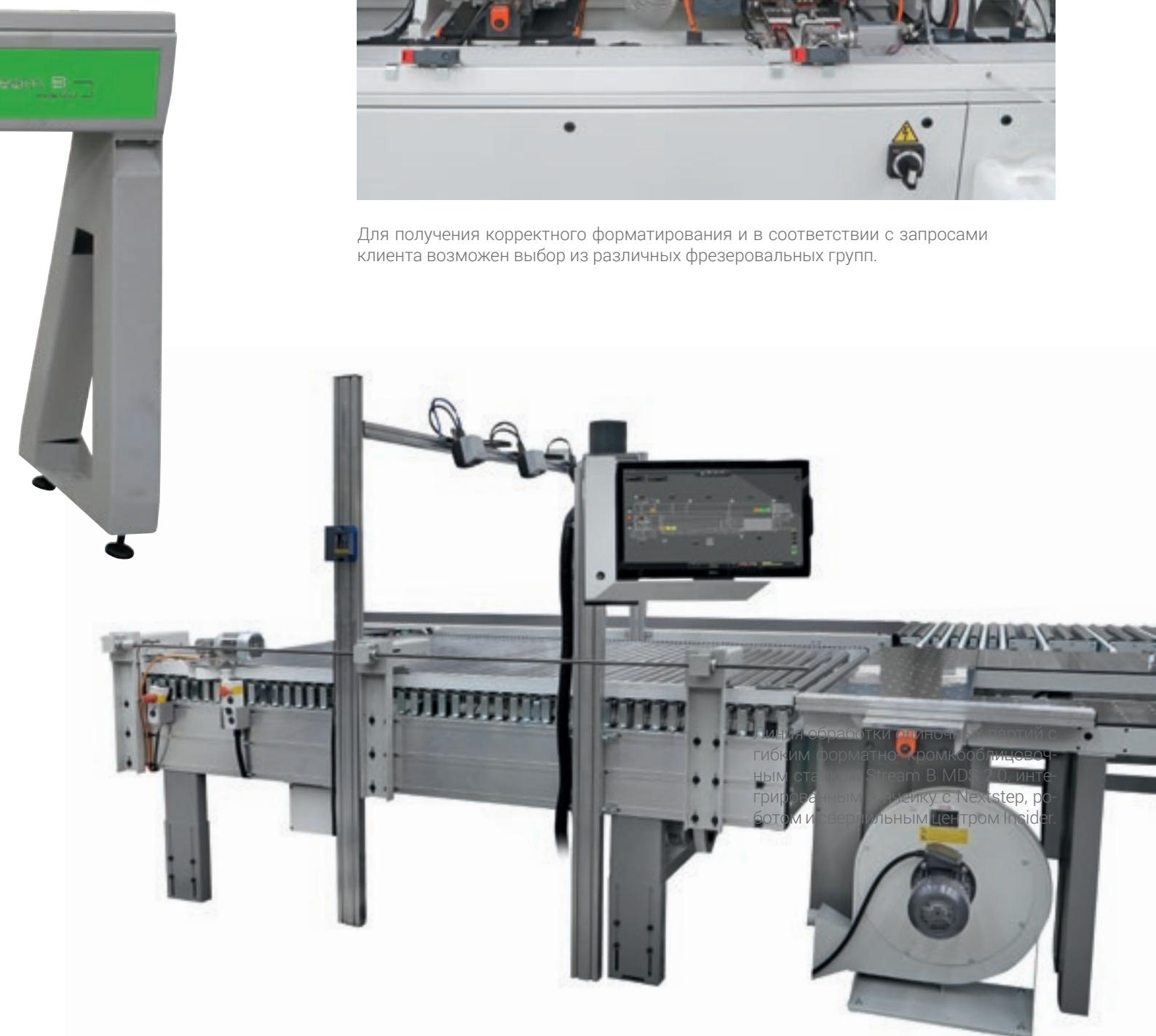
Линия обработки одиночных партий с гибким форматно-кромкооблицовочным стакком Stream В MDS 2.0, интегрированным с ячейку с Nextstep, работой и сверлильным центром Insider.
