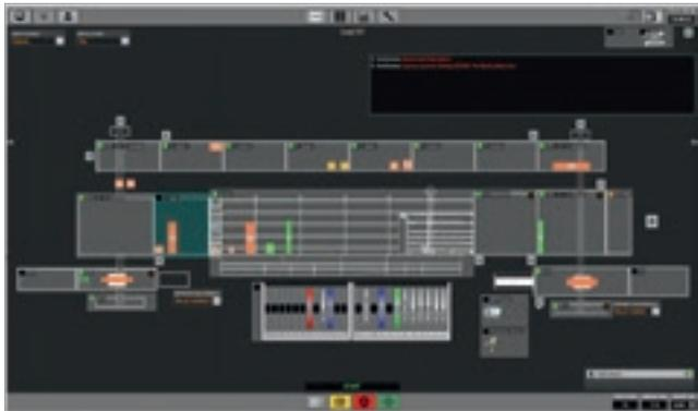
Супервайзер линии управляет потоком материала внутри станка Stream B MDS и позволяет распознавать В РЕАЛЬНОМ ВРЕМЕНИ состояние самого станка, положение и количество панелей и соответствующие рабочие фазы.
