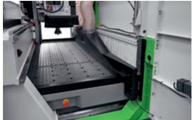
Разгрузочная балка с присосками поддерживает одновременную очистку и разгрузку панелей, избегая ручного вмешательства и тем самым повышая производительность.
