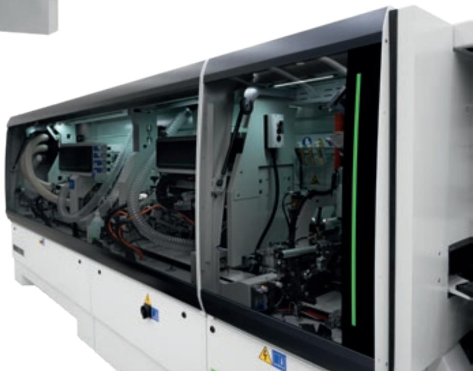
Вертикальный светодиодная панель различных цветов для возможности управления рабочей машиной.
