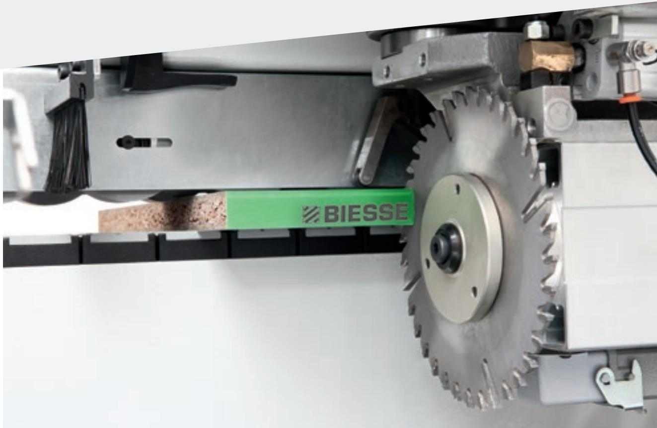
Надёжность и точность обрезки благодаря Торцевальной группе при удалении излишков кромки в начале и в конце панели. Торцевальная группа несёт в базовой конфигурации Систему Flex, позволяющую автоматически производить регулировку излишка кромки.
