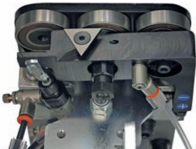
**Группа клеевого скребка**, которая удаляет избыток клея с верхней и нижней поверхностей панели, единственная на рынке, имеющая 4 пневмоцилиндра для высокого качества отделки.
